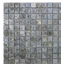
■ STN-307 シルバーグリーン 25 (11シート/㎡) 約1.7kg 寸法：約25x25x10mm (約300x300x10mm/シート)
